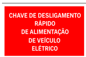
Figura 1 – Sinalização da Chave de Desligamento Rápido
